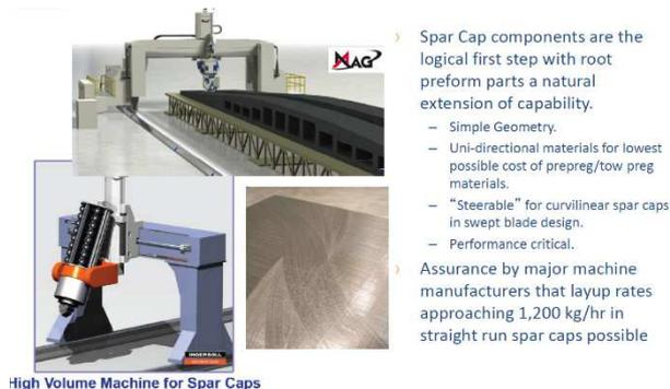
図5 スパーキャップの自動生産システム<sup>6)</sup>
